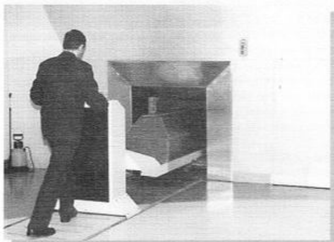
Trumna umieszczana jest w piecu przy użyciu mechanicznego wózka widłowego.
